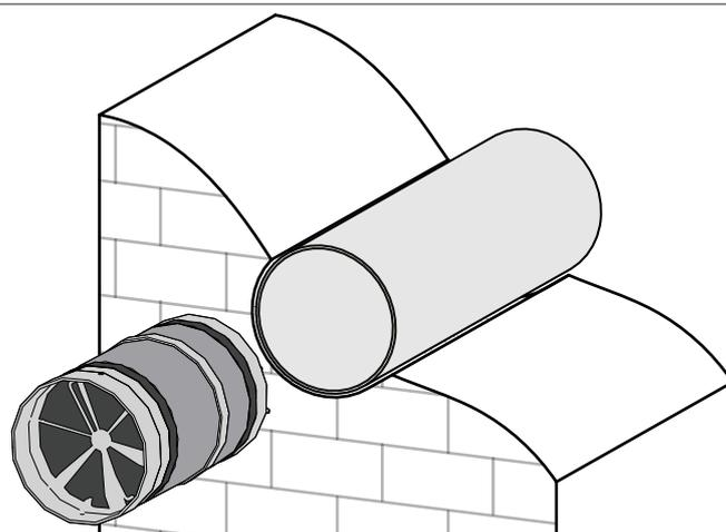
4. С помощью отвертки снимите фронтальную часть блока вентилятора.
