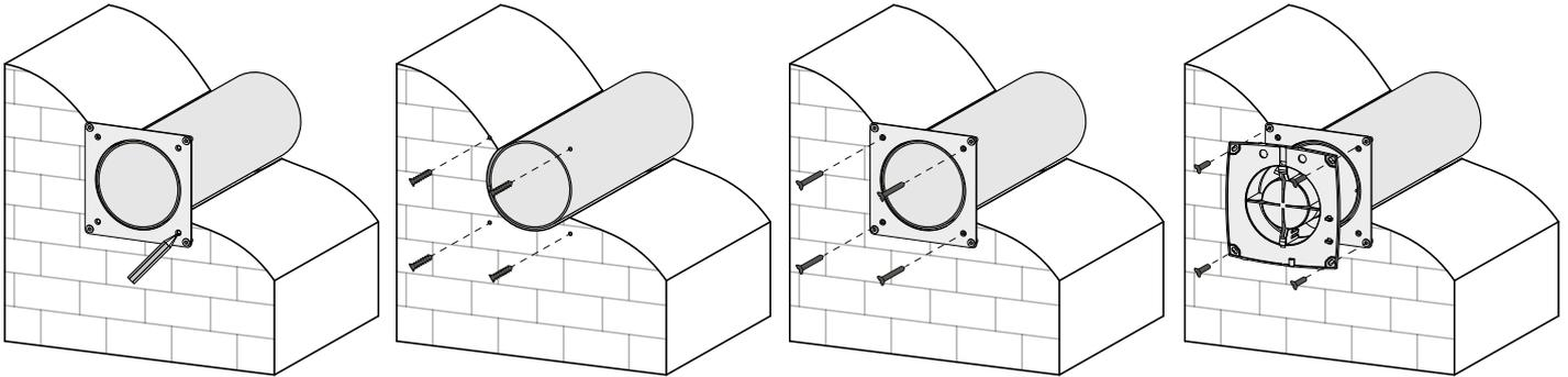
6. Установите фронтальную часть блока вентилятора на прежнее место и закрепите саморезом с помощью отвертки.
