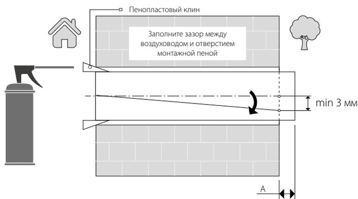
При монтаже воздушного канала обеспечьте наклон со стороны улицы минимум на 3 мм вниз.
