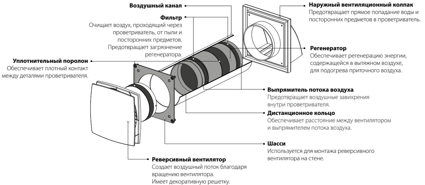
Проветриватель работает в два цикла по 70 секунд.
